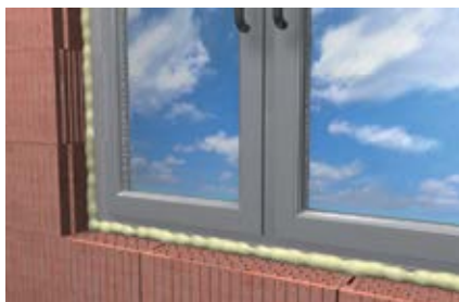
Швы оконных проемов
