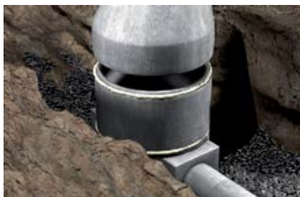
Герметизация бетонных колец канализационных колодцев
