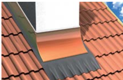
Герметизация фартуков вокруг дымоходов
