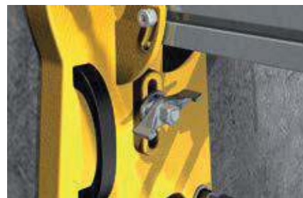
Узел крепления установки для алмазного сверления
