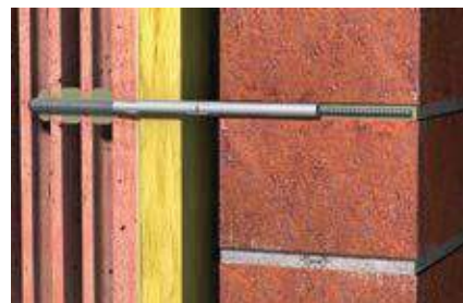
Фрагмент: Восстановление наружного слоя
