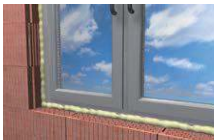
Швы оконных проемов
