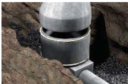
Герметизация бетонных колец канализационных колодцев
