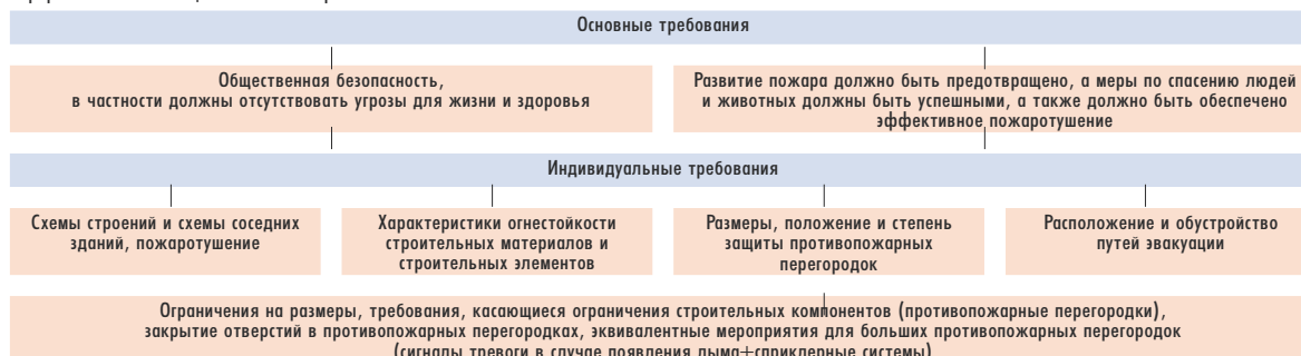
Рисунок 6.3: Требования, которым должны соответствовать строительные сооружения для обеспечения эффективной защиты от пожаров /3/.
